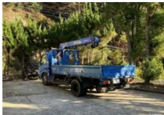
写真 供給先の入浴施設までの輸送は、ユニック車で積み下ろし、運搬を行っている
