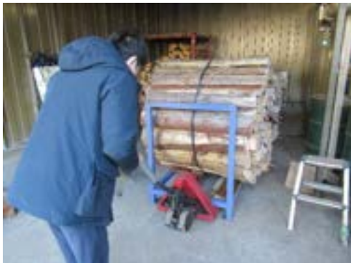
写真 黄金泉のボイラー脇には、薪束がそのまま入るラックがあり、ハンドリフトでボイラーの投入口まで移動する仕組みになっている。
