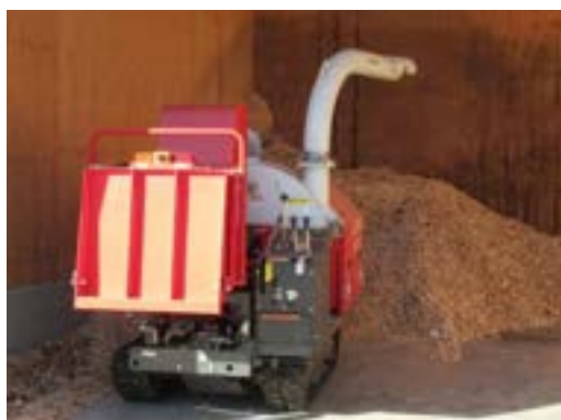
写真 屋内作業に使われている小型のチッパー
