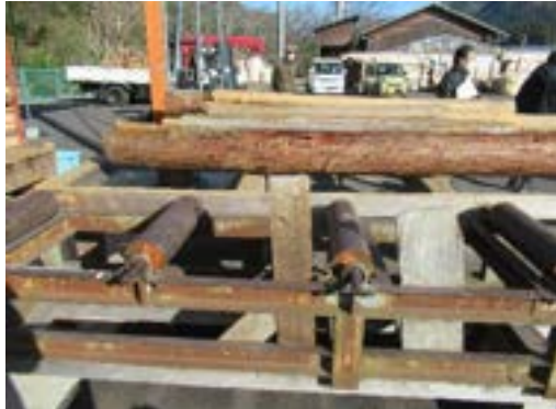
写真 原木はローラーコンベアに載せて、建屋内の玉切り台へ送られる。
