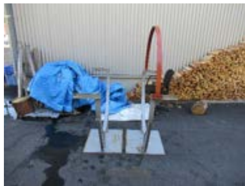
写真 特注バンドリング装置(側面) 上部の押さえは 1ヶ所の方が作業性が良いとのことであった。
