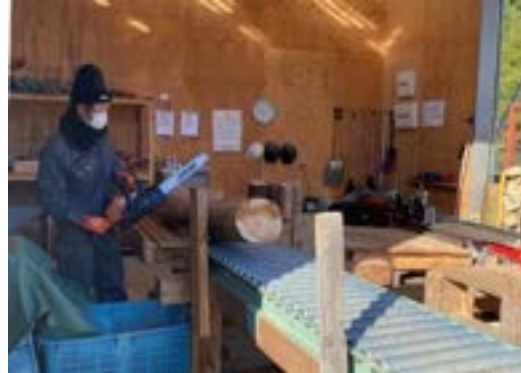
写真 玉切りは、ローラーコンベアと高さを合わせた作業台に原木を固定して玉切りを行っている。
