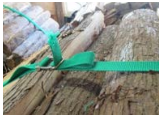
写真 繰り返し使えるベルトで荷造り用締め具を使って結束
