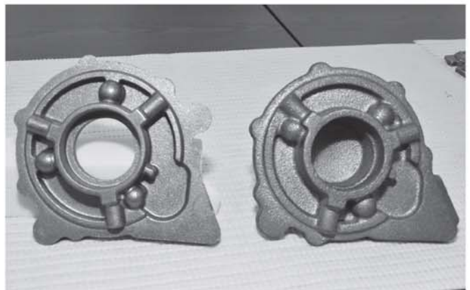
▲どちらも同じ製品ですが、右が他社製品で、左が会津工場の製品です。会津工場の製品は必要な穴あけ加工などが鑄造段階で行われている事が分かります。
