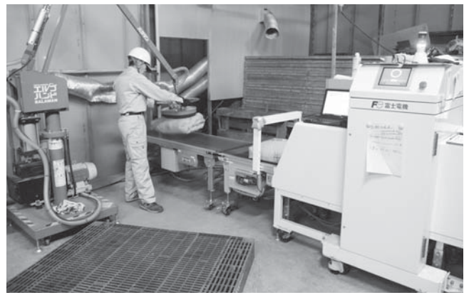
▲検査機器に30kgの米袋を乗せて計測する検査員
