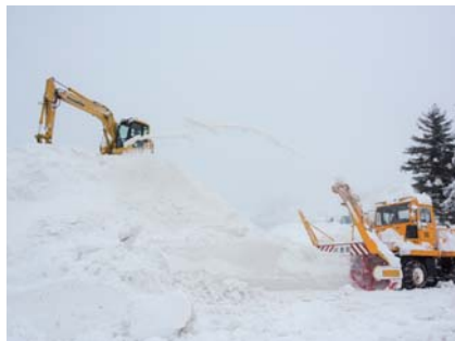
▲ロータリーやバックホーなどの重機を巧みに操り大きな雪山をつくる現場
